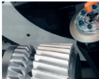
Rettifica di un ingranaggio di grosso modulo con mola CBN elettrodeposta
