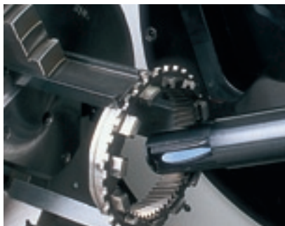
Rettifica di ingranaggio interno elicoidale
