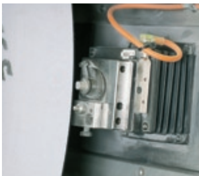
Unità di diamantatura con diamante di sgrossatura e finitura
